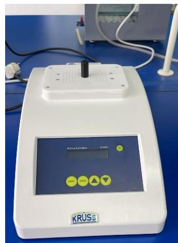
**Измеритель точки плавления M5000**
